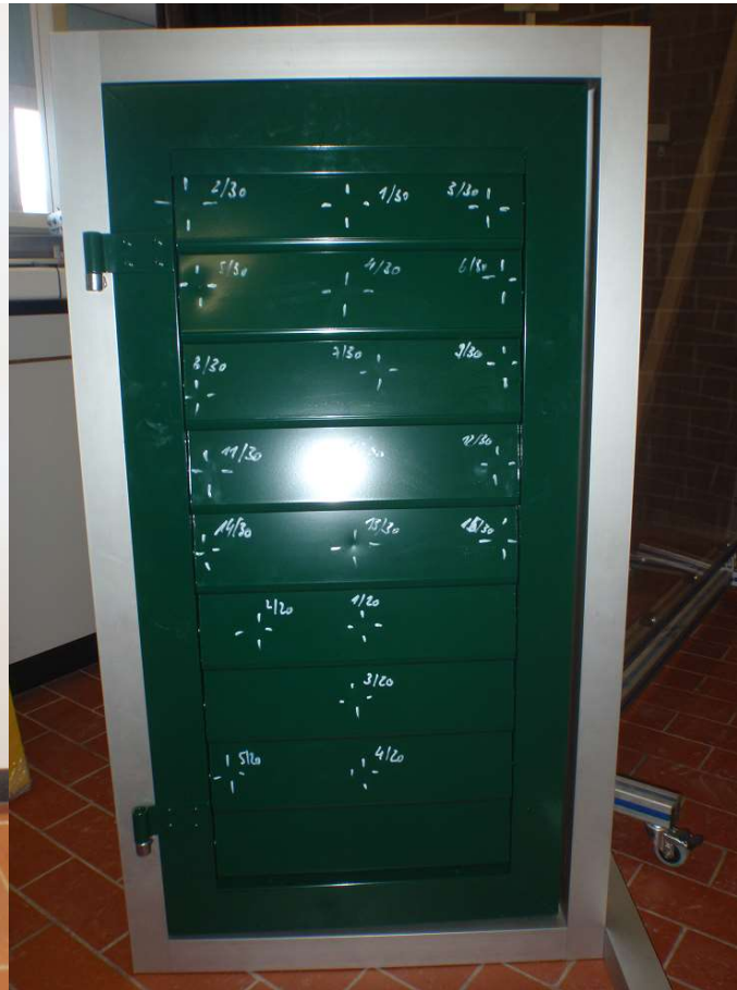
Bild 5: sichtbare Dellen infolge Beschuss mit 3 cm- EK
