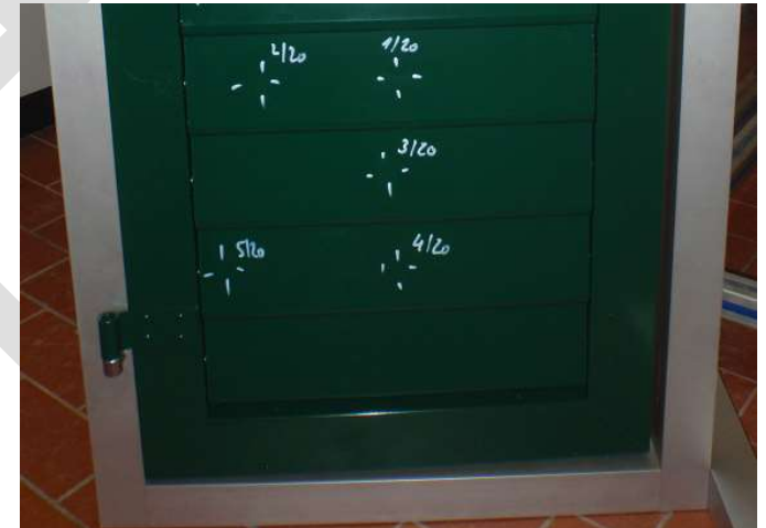
Bild 6: Keine Beschädigung infolge Beschuss mit 2 cm EK
