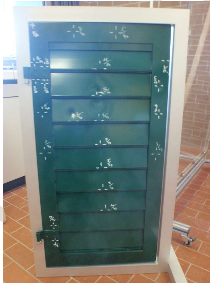
Bild 2: Beschuss mit 5 cm EK, Sichtbare Dellen in Fläche Rahmen, Kante Lamelle und Fläche Lamellen
