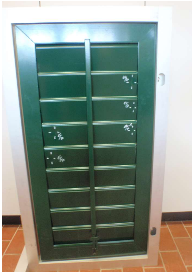
Bild 4: Beschuss der Rückseite mit 5 cm- EK zur Überprüfung der Funktion Mechanik der beweglichen Lamellen am Auflager der Lamellen
