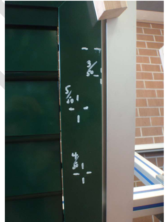
Bild 3: Sichtbare Delle (5/50) in Fläche Rahmen bei Beschuss mit 5 cm EK
