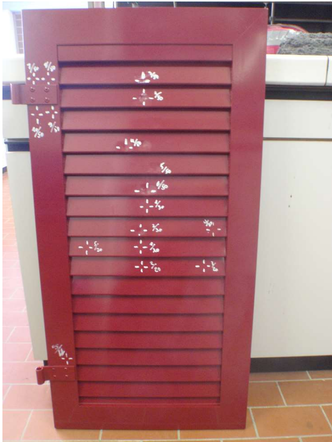
Bild 1: Beschuss mit 5 und 3 cm EK, Sichtbare Dellen in Kante Lamelle und Fläche Lamellen
