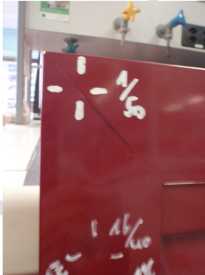
Bild 2: Beschuss mit 5 cm EK, Sichtbare Delle und Beschädigung (1/50) in Rahmenecke
