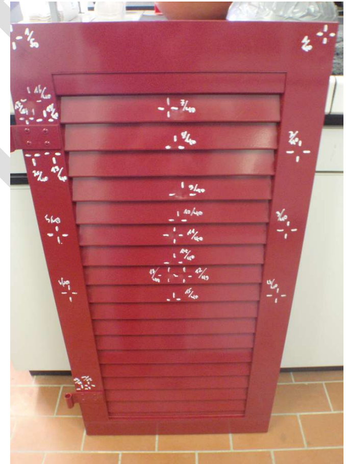
Bild 3: Beschuss mit 4 cm EK, sichtbare Dellen in Rahmenfläche und Lamellen
